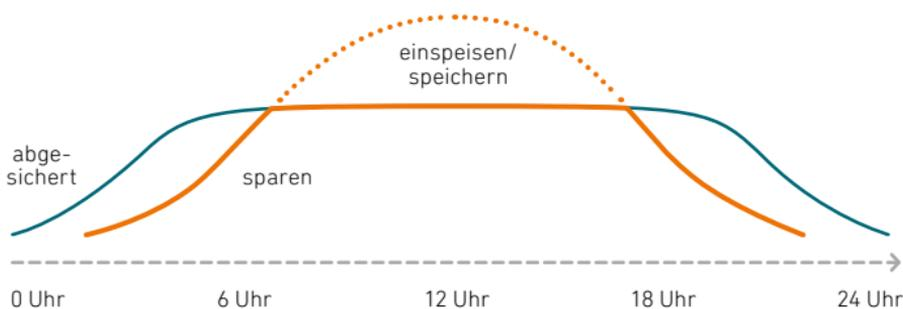
Schematische Darstellung der PV-Leistung im Tagesverlauf
